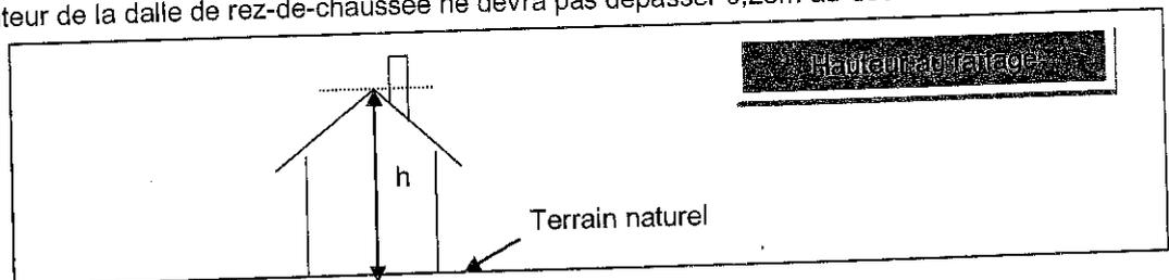
La hauteur totale est mesurée entre le faîtage et le point le plus bas du niveau du sol naturel.
